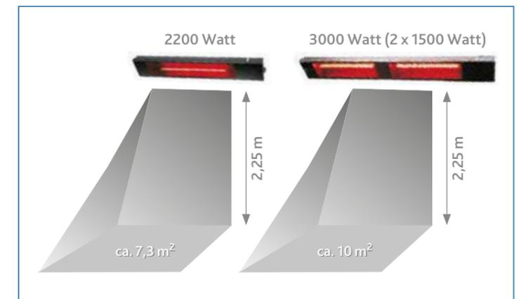
Erwärmungsflächen Infrarotheizstrahler Relax Glass io IP65
